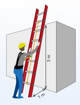
Cuando la apoyes contra una pared u otro elemento, hazlo en un ángulo de unos 65-75° con respecto a la horizontal, es decir, separa la parte inferior aproximadamente 1 m de la pared por cada 3 m de altura hasta el punto de apoyo de la escalera.
