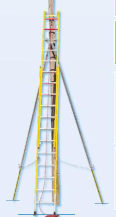
Si no puedes comprobar la parte enterrada de un poste (rodeada de hormigón, asfalto...) considera que no es resistente.
